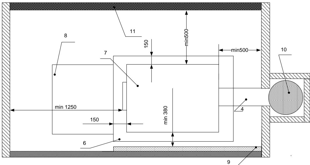
Котел «КОСМОС» (КМВ) (7) устанавливается на подготовленное основание (6) с соблюдением минимально безопасных расстояний: до стены расположенной напротив топочной дверцы 1250мм, от задней стенки котла до незащищенной стены 500мм, от боковой стенки котла до незащищенной стены (11) 500мм, от боковой стенки котла до защищенной
