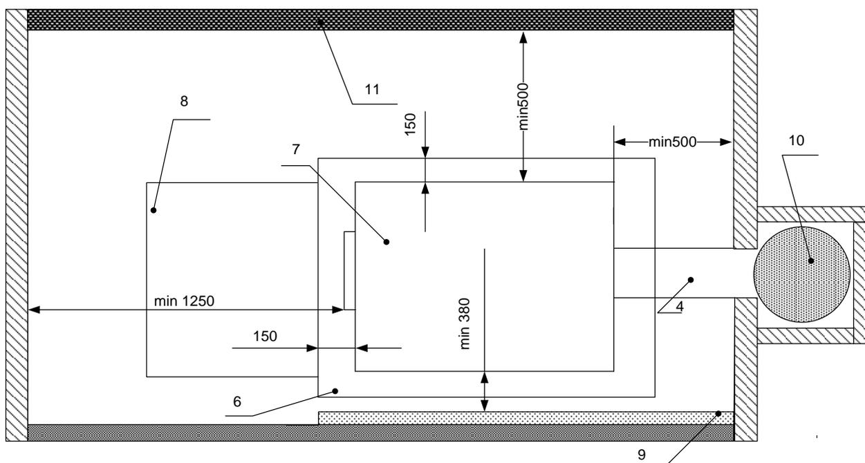
Котел «КОСМОС» (КМВ) (7) устанавливается на подготовленное основание (6) с соблюдением минимально безопасных расстояний: до стены расположенной напротив топочной дверцы 1250мм, от задней стенки котла до незащищенной стены 500мм, от боковой стенки котла до незащищенной стены (11) 500мм, от боковой стенки котла до защищенной
